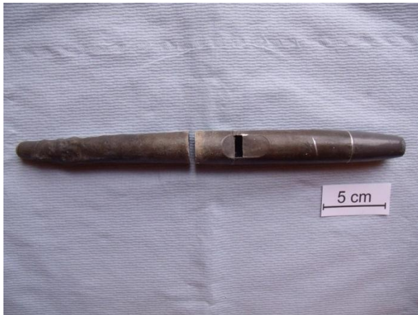
Abb. 11: Durchtrennter Pfeifenfuß einer historischen Blockflöte mit abgelagerten Korrosionsprodukten im Innern
