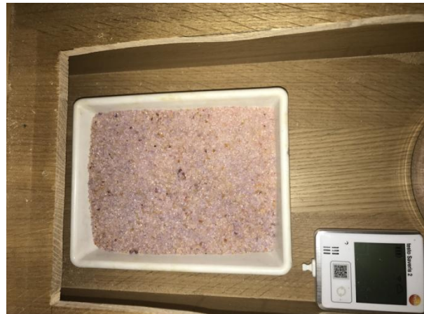
Abb. 14: geöffnete Wartungsklappe nach sechs Wochen. Das feuchte Silicagel hat die blaue Farbe verloren
