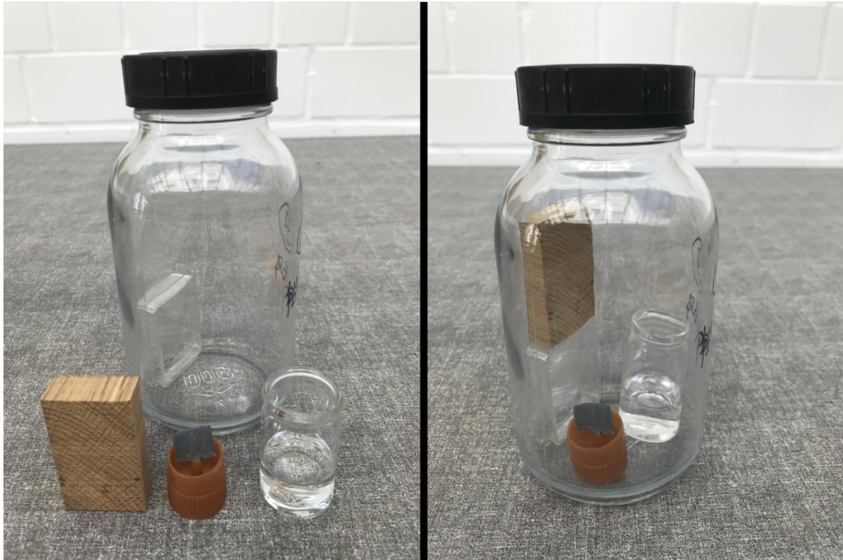
Abb. 20: Aufbau des Oddy-Testes
