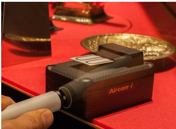
Abb. 33: AirCorr-Sensor in einer Vitrine im Einsatz
