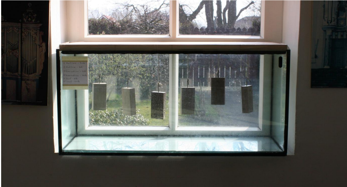
Abb. 47: Versuchsbehälter zum Test der Beschichtungen bei Essigsäure-Belastung
